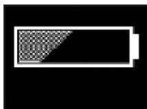
Le symbole de la batterie à moitié pleine indique qu'il est nécessaire de recharger la batterie.
